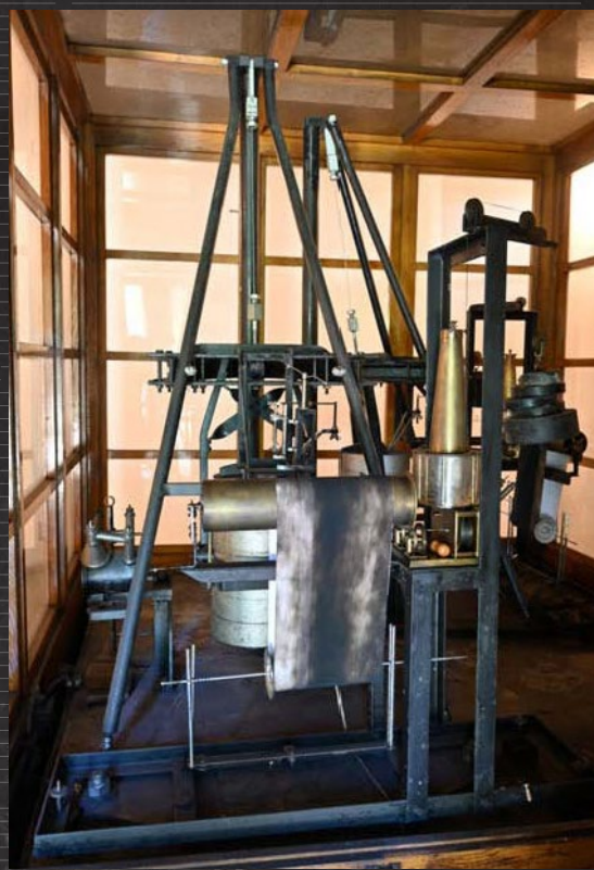
Obr. 4. Horizontálne seizmografy typu Mainka (z rozličných uhlov) sú v Hurbanove plne funkčné aj dnes
