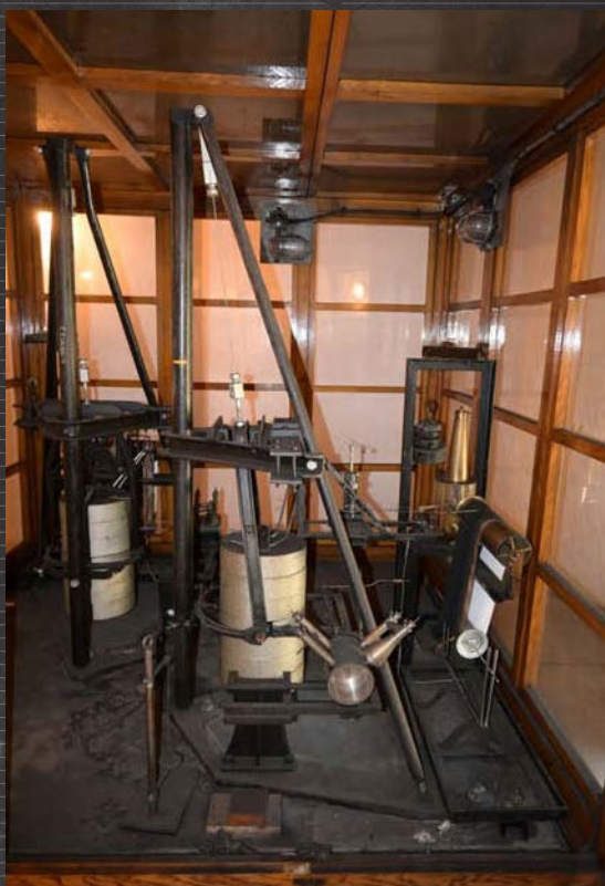
Obr. 4. Horizontálne seizmografy typu Mainka (z rozličných uhlov) sú v Hurbanove plne funkčné aj dnes
