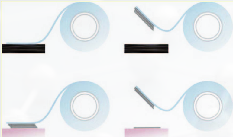
Obr. 3 Prenos grafénu z povrchu grafitu na substrát
